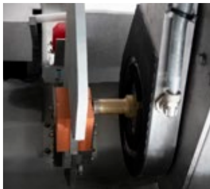
Sistema di misurazione e ravvivatura foretti integrato nella configurazione base della macchina.
