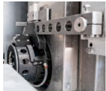
Ravvivatore stick per la ravvivatura delle mole diamantate e dispositivo di rettifica delle mole lucidanti.
